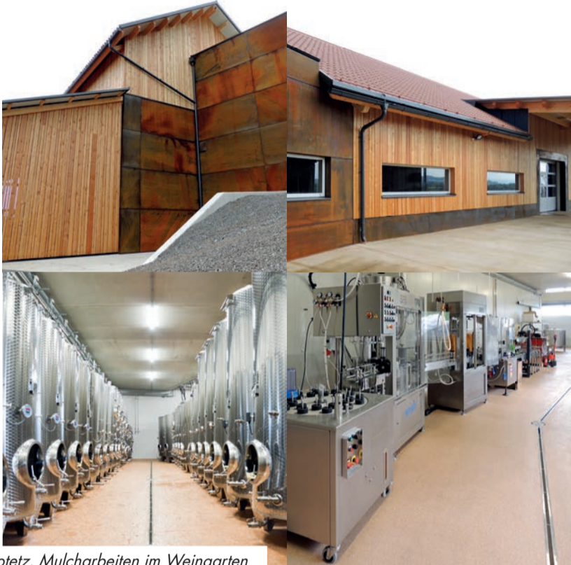
Klapotetz, Mulcharbeiten im Weingarten Die neue Fassade des Weinkellers aus Lärchenholz und Cortenstahl Edelstahltanks im Weinkeller, unsere Füllanlage
